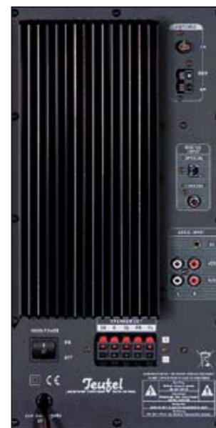
Auf der Rückseite des Subwoofers finden Sie Anschlüsse für drei analoge Geräte und zwei Signalquellen mit digitalen Ausgängen
